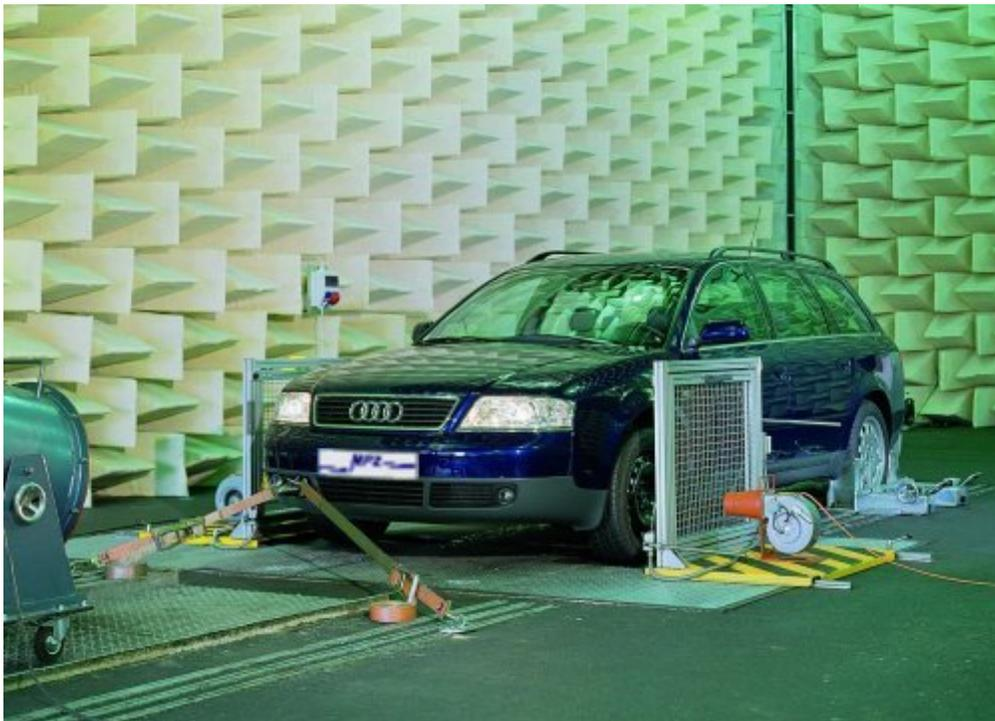
Abbildung 4.2- Rollenprüfstands-Messung an einem Pkw [mpz /16/ 2005]
